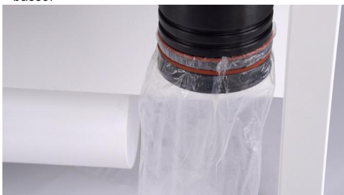
16. Fissare il sacco di smaltimento interno sull'anello di fissaggio e introdurlo nel sacco principale dall'alto.
