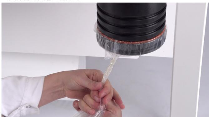
6. Sigillare ermeticamente la parte piegata con un attrezzo di crimpatura E-Crimp oppure con un attrezzo Crimp-Lock manuale (in zone EX) (vedere il manuale d'uso dell'attrezzo di crimpatura corrispondente).
