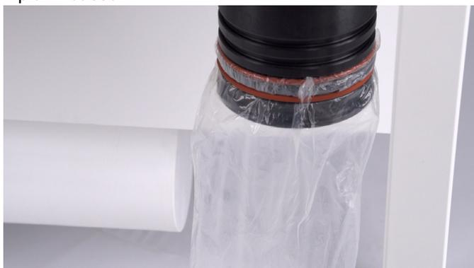
2. Fissare il sacco di smaltimento interno sull'anello di fissaggio.
