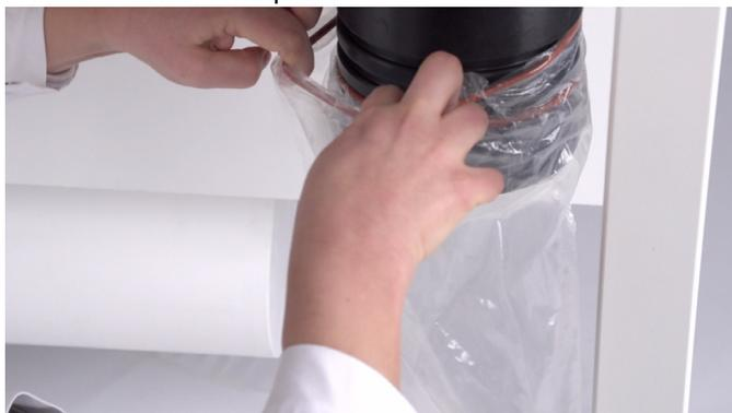
12. Fissare il sacco principale con un O-Ring nella scanalatura superiore.
