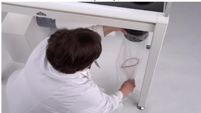
15. Tirare leggermente verso il basso il nuovo sacco principale, in modo che l'O-Ring entri nella seconda scanalatura partendo dal basso. Se necessario, fissare il sacco con un ulteriore O-Ring nella scanalatura più in basso.
